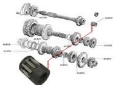
roulement à aiguille arbre primaire
