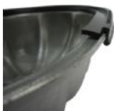
Couvercle de soupape joint 2CV, version spéciale.
