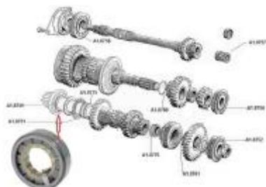
Roulement de boîte de vitesse 2CV
