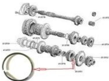
Segment d'arrêt de 4ème vitesse
