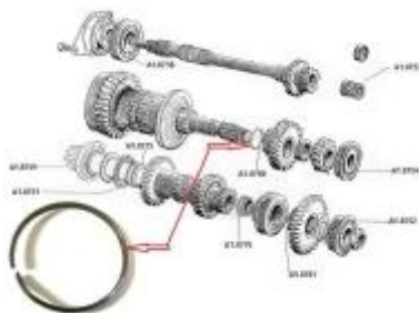
Segment d'arrêt de 2ème et 3ème vitesse
