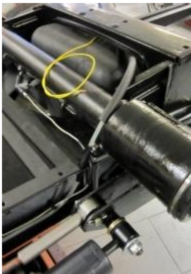
Ligne de freins et de carburant
