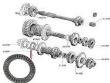
Roulement à aiguille de boîte de vitesse
