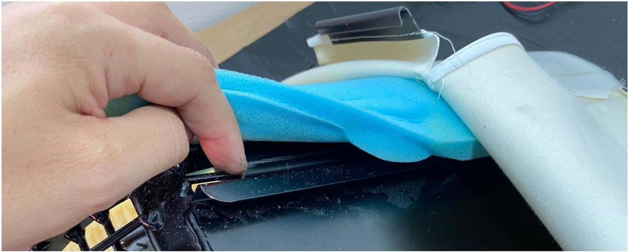
Il y a également une gouttière au dos du siège, accessible plus ou moins à tâtons – pas très visible, tout au fond (la vue est prise depuis la base du siège vers le haut, à l'arrière du dossier) :
