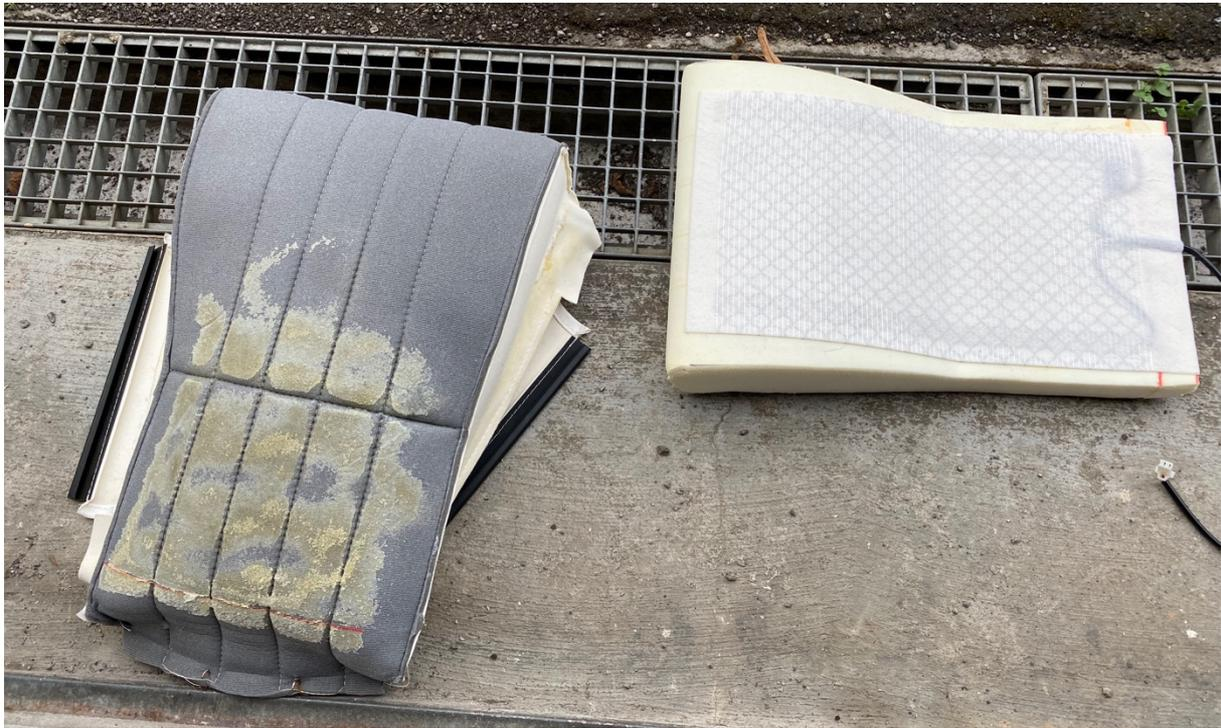
Pour le dossier, et contrairement à ce qu'on voit sur la photo (c'était une tentative qui n'a pas fonctionné), il faut couper l'élément chauffant à hauteur de la fente qui permet d'accrocher la gouttière. Pour ma part j'en ai profité pour ajouter une couche de 8mm de mousse sur le dossier, directement sur le métal. L'élément chauffant est ensuite collé au-dessus de cette couche de mousse.
