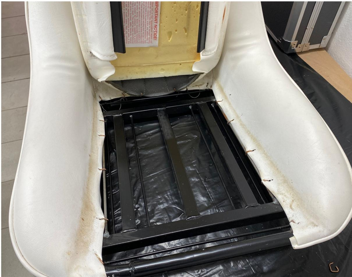
Une fois l'assise détachée, il faut décoller le cuir de la mousse. Ça vient bien si on fait doucement. Repérer les zones collées (assise au niveau de la fausse couture, au dos les pattes de fixation) pour recoller au moins aux mêmes endroits au remontage.
