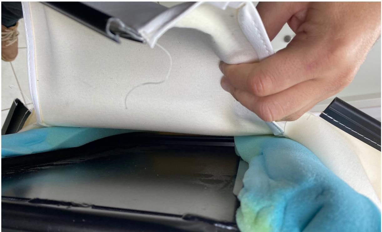
Ça devrait être la dernière opération avant d'arriver à la structure nue du siège. Comme on disait plus haut, le dossier ne dispose pas de mousse, il faudra fixer l'élément chauffant directement sur le métal. On peut également en profiter pour ajouter justement une petite couche de mousse sur le dossier d'abord, histoire d'améliorer le confort. Dans tous les cas il ne faut pas recouvrir l'élément chauffant.
