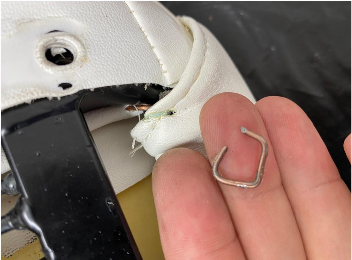
L'assise tient à la structure avec seulement deux anneaux, encore attachés ici :
